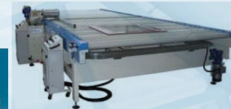
de esmaltação automáticas. Nesse último caso, são equipadas com um Glassdrier IR e sistemas transportadores. Seu último lançamento (Glassline) é uma esmaltadora de bordas de vidro plano, cujo princípio se baseia nas técnicas de esmaltação através de cilindros reversos.
