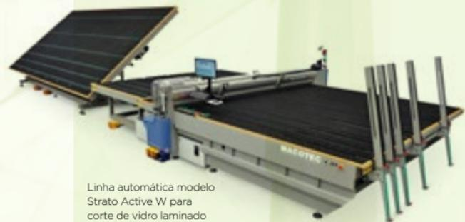
Linha automática modelo Strato Active W para corte de vidro laminado
