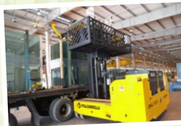
200R, uma empilhadeira com mastro retrátil multidirecional, capaz de movimentar até 20 toneladas de vidros em cavaletes e de realizar o carregamento em caminhões de maneira ágil e segura. A versão EN4L 150C vem equipada com um acessório que, além dos vidros em cavaletes, também permite movimentar o vidro em colares.
