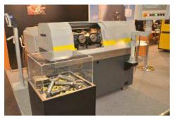
paquímetros, micrômetros, bancos dedicados e etc. Além disso, suas medições independem das variações de temperatura, bem como de possíveis erros manuais cometidos pelos operadores. Capacidade de visão de diâmetros 23x34 mm, 60x80 mm e 24x400 mm, onde todas as medidas são tomadas de uma só vez, em fração de segundos. Também presente na Mecânica a
