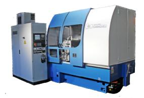
confiabilidade, eficiência e precisão. Atualmente incluem os modelos M100, APG-S, APG-M e CF400, ideais para retificação em mergulho de peças de diâmetros variáveis, ou com ciclo de trabalho que incluem peças cilíndricas. Podem ser dotadas de rebolos com diâmetro de 406 – 508 – 610 - 762 mm e largura de 100 mm (no modelo M100), de 152 a 254 mm (no modelo APG-S), de 305 mm (no modelo APG-M) e até 400 mm (no modelo CF400).
