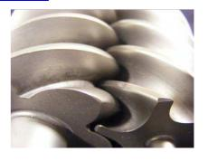
injeção de óleo – 2,2/450KW); SCI SERIES (compressor de parafuso com injeção de óleo – 3/55KW, utilizado em aplicações especiais, graças à reduzida dimensão. Já vem equipado com filtro de óleo, separador, válvulas de controle de pressão – todas produzidas pela TM.C. – e reservatório de óleo); SLC SERIE (isento de óleo, utilizado em caminhões tanque, em sistemas pneumáticos ou estacionário).
