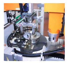
máquinas VPUBK30-TO (para o balanceamento de discos de freios, equipada com carregador automático, contentores na entrada e saída e proteção para aparas - correção do desbalanceamento estático por meio de fresagem) e ZBK100-TA (balanceadora automática compacta para virabrequins — correção dos desbalanceamentos por meio de furação, enquanto uma garra hidráulica assegura que o virabrequim não se curve durante a operação).
